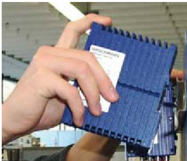
Рисунок 3.3 - Монтаж модуля серії Rail на DIN-рейку
